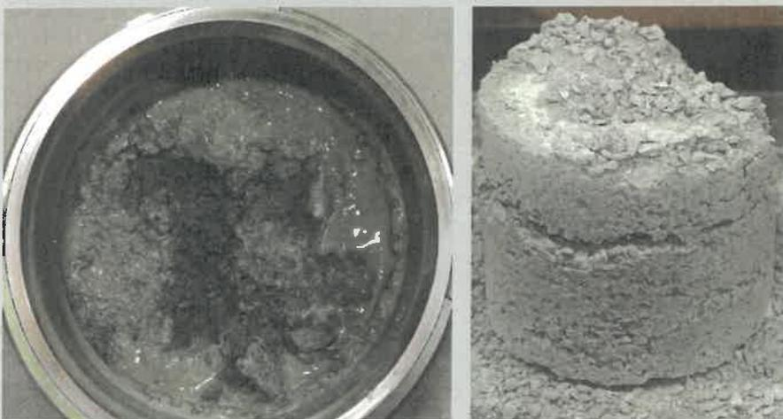
Bild 18: Optisches Erscheinungsbild des Diabas „P“ nach einmaliger Beanspruchung im feuchten Zustand
