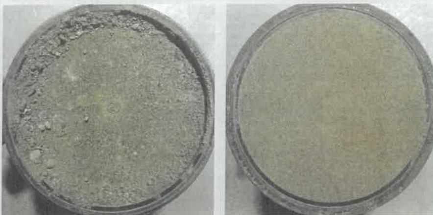
Bild 16: Optisches Erscheinungsbild des Recyclingmaterials „J“ nach einmaliger Beanspruchung im lufttrockenen Zustand
