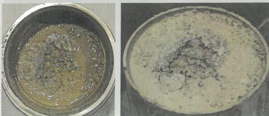
Bild 19: Optisches Erscheinungsbild des Recyclingmaterials „J“ nach einmaliger Beanspruchung im feuchten Zustand
