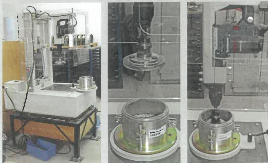
Bild 15: Vibrationshammer nach DIN 13286-4
