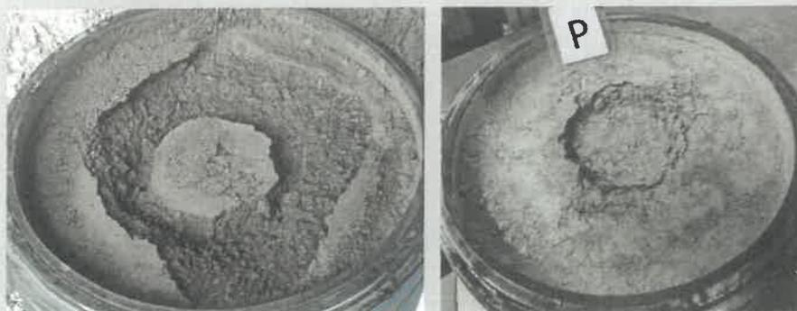
Bild 20: Optisches Erscheinungsbild der Oberflächen der Proben nach Abschluss des CBR-Versuchs nach 12-monatiger Beanspruchung
