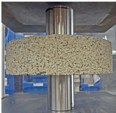
Bild 5: Bestimmung der Druckfestigkeit des Bettungsmörtels
