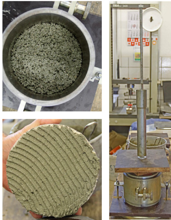
Bild 3: Herstellung der Haftzugprüfkörper
