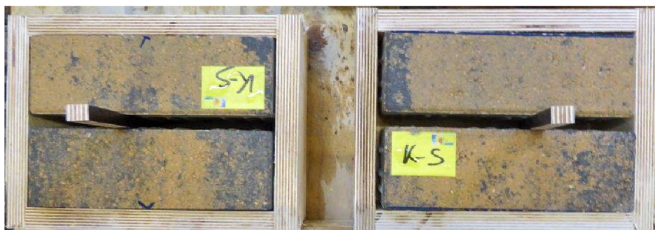
Bild 9: Prüfkörper zur Bestimmung der Haftzugfestigkeit
