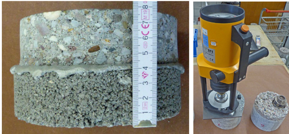
Bild 8: Bestimmung der Haftzugfestigkeit des Verbundprüfkörpers
