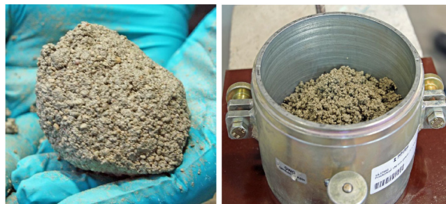
Bild 1: Schneeballtest und Einbringen des Bettungsmörtels in die Prüfkörperform
