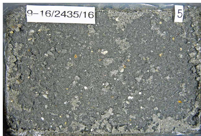
Abb. 2: Betonpflastersteine mit einer Abwitterungsrate von 150 \text{ g/m}^2 (links) bzw. 1.430 \text{ g/m}^2 (rechts) im Rahmen des Slab-Tests
