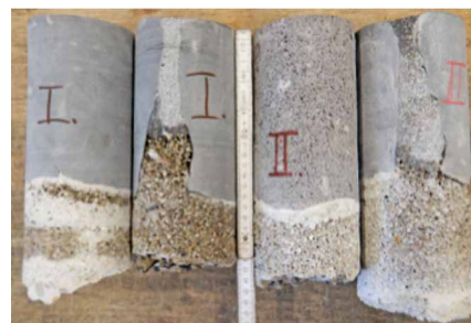
Abb. 10: Bohrkern zum Nachweis der Produkteigenschaften
