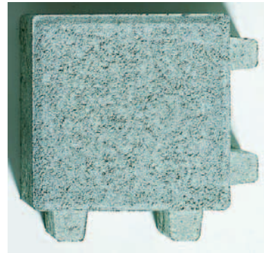
Bild 8: Nicht weiter bearbeitete Oberfläche eines im Rüttelpressverfahren hergestellten Pflastersteins. USRV-Wert ca. 70.
