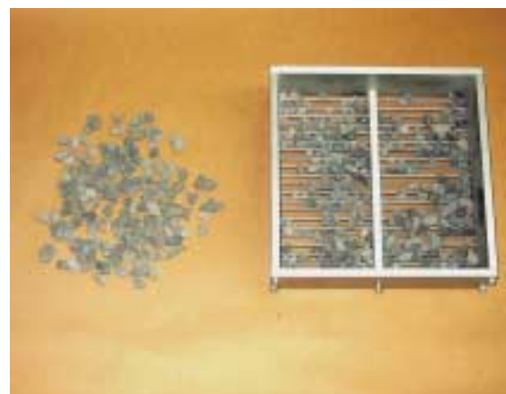
Bild 1. Untersuchung einer gebrochenen Gesteinskörnung mit dem Stabsieb; links: plattige Körner, rechts: Stabsieb mit kubisch geformten Körnern
